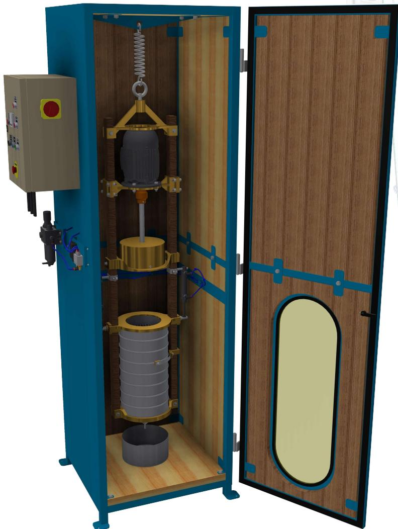
São indicados para análises granulométricas de amostras em laboratório. Podem operar a seco ou a úmido.
