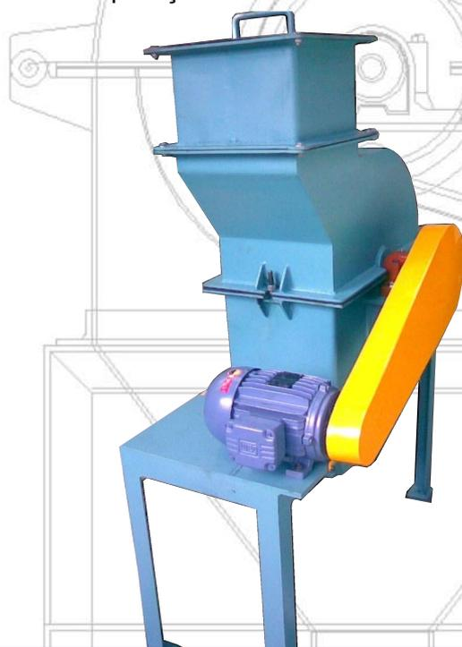
O princípio de funcionamento está baseado no movimento de um rotor que gira em alta velocidade no interior de uma carcaça gradeada.
